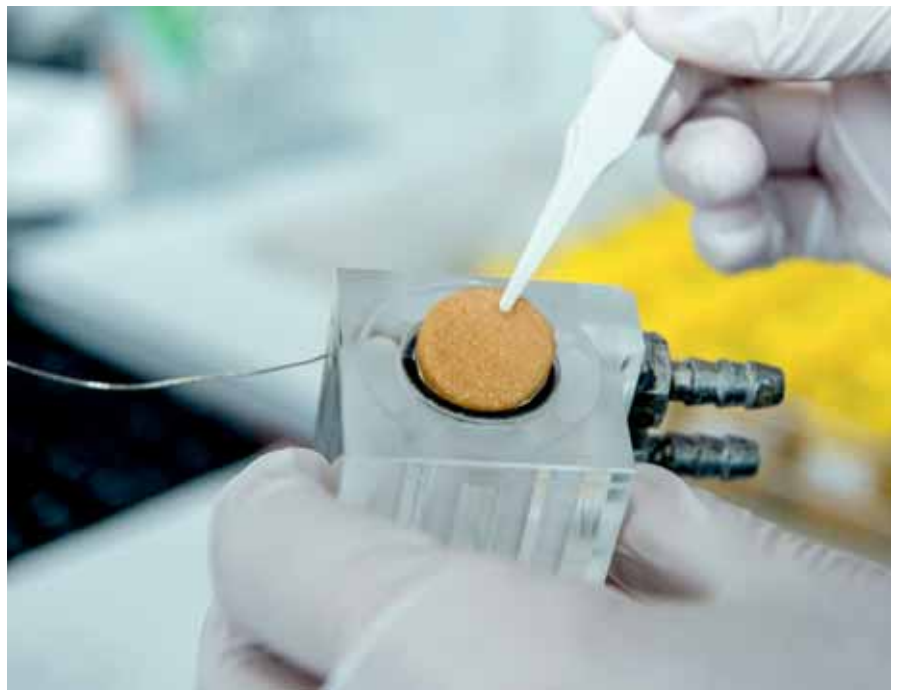
Vorreiter für den Klimaschutz: Im Labor charakterisieren die RUB-Forscherinnen die Gas-Separatoren zum Beispiel im Hinblick auf Gasdichte und Ionenleitfähigkeit Foto: RUB
