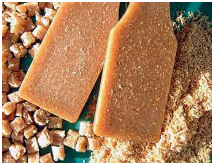
Beispiel für einen Kunststoff aus nachwachsenden Rohstoffen: Wood-Plastic-Composite (WPC)-Granulat und Prüfkörper mit dem eingesetzten Holzmehl
