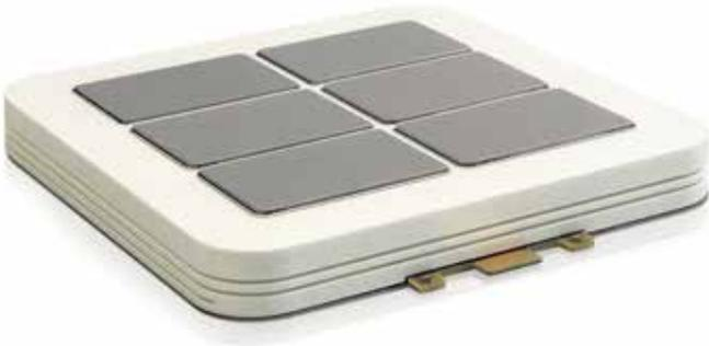
Bimode Insulated Gate Transistors: Die neue Generation verlustarmer Thyristoren bewirkt weitere Effizienzsteigerungen im Bereich der Energieübertragung;
