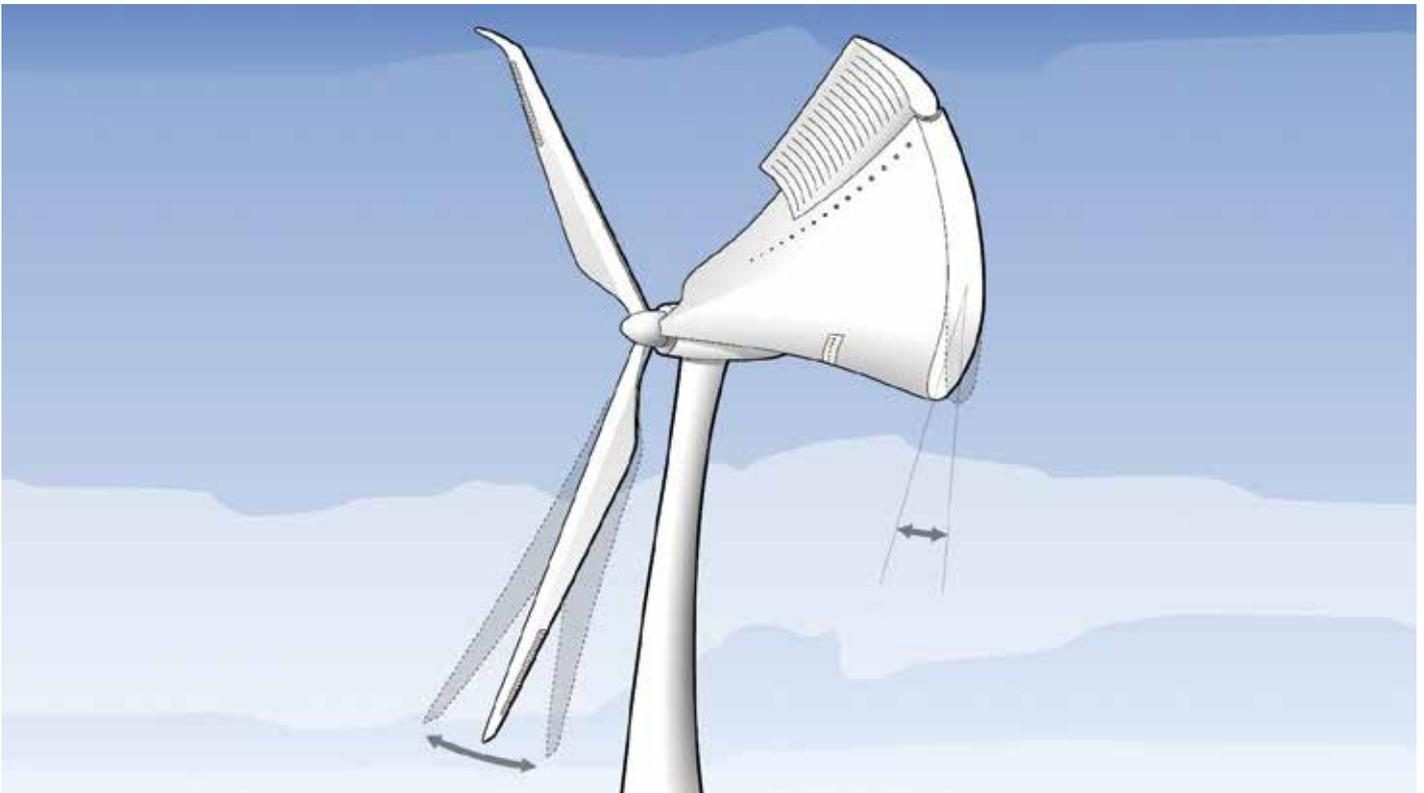
Smart Blades: Schnelles Anpassen an die Windbedingungen. Durch Klappen im Rotorblatt, die den Wind umlenken sowie bewegliche Hinterkanten und Vorflügel sollen sich Rotorblätter in Zukunft besser und schneller an die lokalen Windströmungen anpassen können; Bild: DLR
