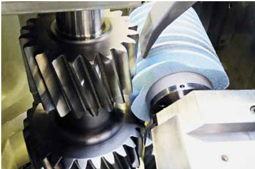
Bild 1: Wälzschleifen eines Zahnrades mit Störkontur, hier ein benachbartes Zahnrad.
