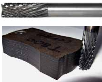
Kompressionsfräser: Die besondere Schneid-geometrie führt zu einer deutlich besseren Spanabfuhr bei Faser-Verbundwerkstoffen.
