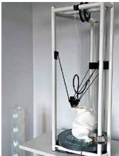
3D-Druck in FDM-Technologie (Fused Deposition Modeling) eines Objekts vom Solinger Künstler Stefan Seeger.
