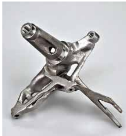
Strukturoptimierter Radträger eines Ultraleichtfahrzeugs: Design für Additive Manufacturing – Herstellung im 3D-Drucklabor Metall und Strukturwerkstoffe am Fraunhofer EMI.
