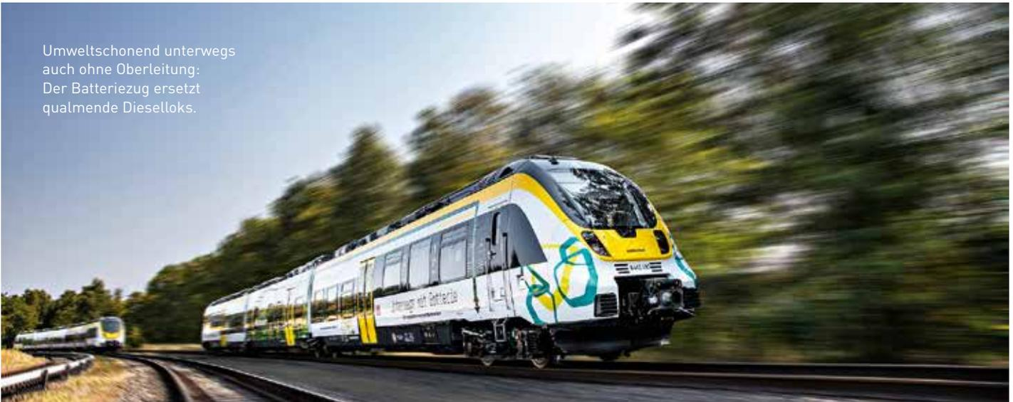
nicht elektrifizierten Strecken Strecken von bis zu 100 km zurücklegen können. 2019 startet die Deutsche Bahn (DB) in der Region Alb-Bodensee einen zwölfmonatigen Probebetrieb mit Passagieren mit dem aktuellen Prototyp.
