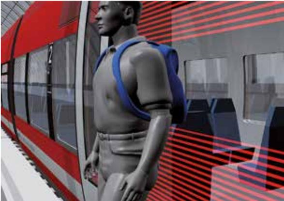
Das vollautomatische Sicherheits-Lichtgitter
