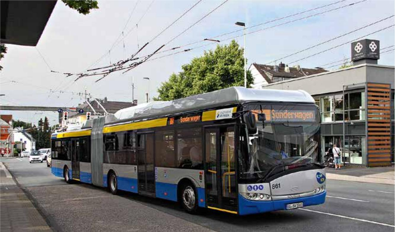
Musterstadt Solingen: Durch die Einführung von 20 Batterie-Oberleitungsbussen (BOB) über die Projektlaufzeit wird es möglich, bislang teilelektrische oder sogar reine Dieselbuslinien komplett elektrisch zu befahren.
