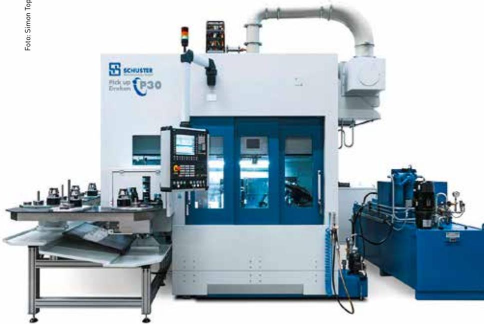
Die P30 Ein-/Doppelspindel Pick-up-Drehmaschine von Schuster
