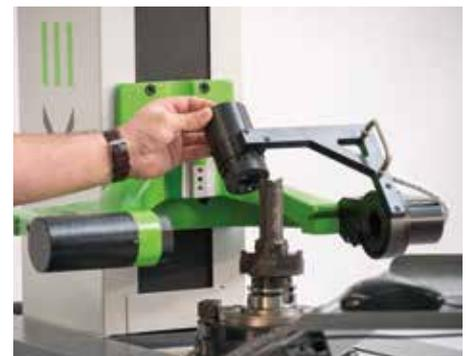
Für eine hohe Fertigungsgenauigkeit bei maximaler Effizienz der Fertigungsressourcen ist es wichtig die Werkzeuge über leistungsstarke Werkzeugeinstellgeräte präzise einzustellen.
