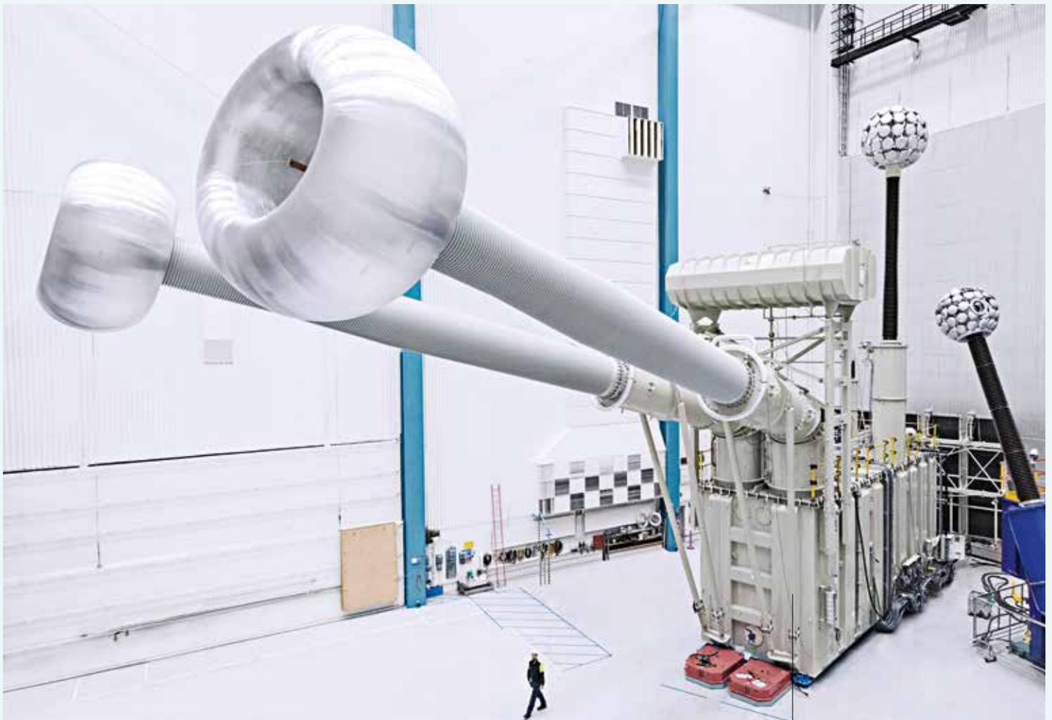
haben. Erhöht man die Anzahl der Wicklungen an der Sekundärspule, dann erhöht sich auch die induzierte Spannung. Der umgekehrte Fall gilt aber auch! So kann aus einer 220 V Wechselspannung durch Verminderung der Anzahl der Sekundärwicklungen eine weit geringere Spannung erzeugt werden.
