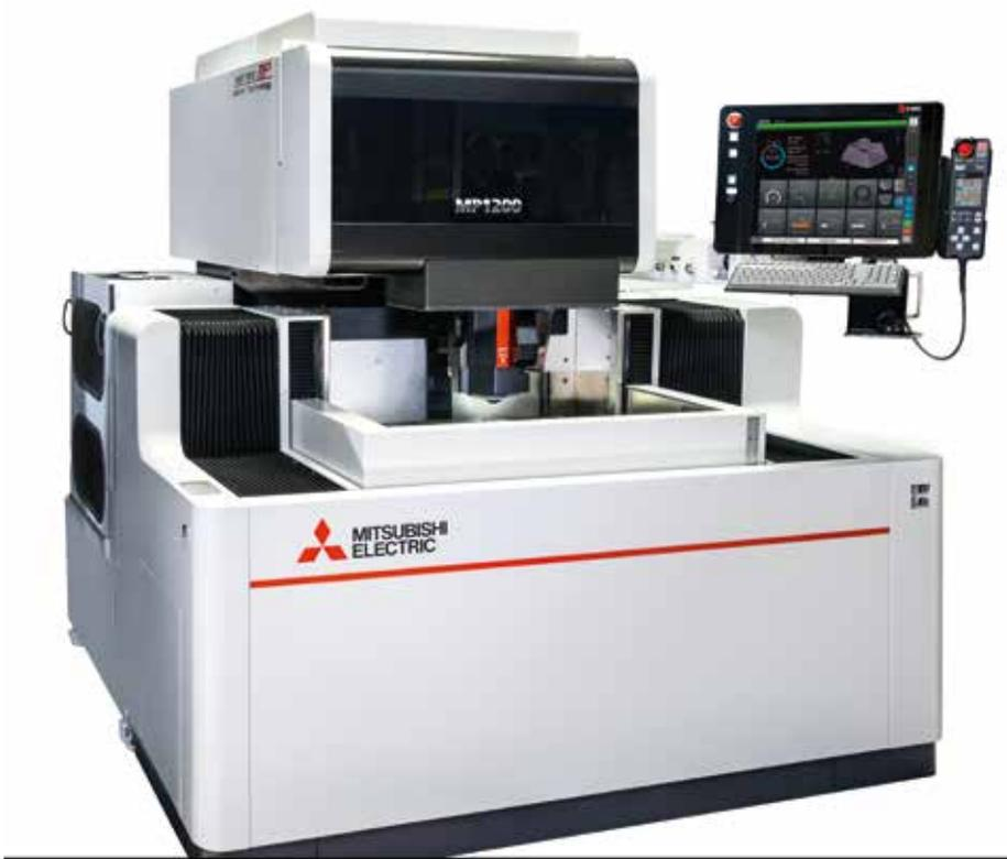
Drahterodiersystem von Mitsubishi Electric mit Steuerung aus dem eigenen Haus.
