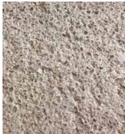
Detailaufnahme Dämmputz mit Aerogel-Granulat.
