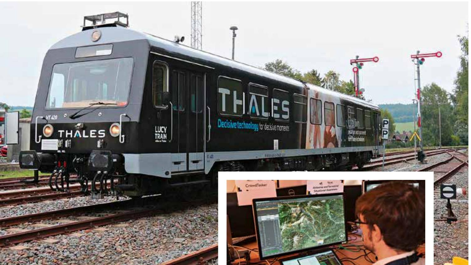
Führerlos: Der Test-Zug wird Mobilfunk gesteuert.
