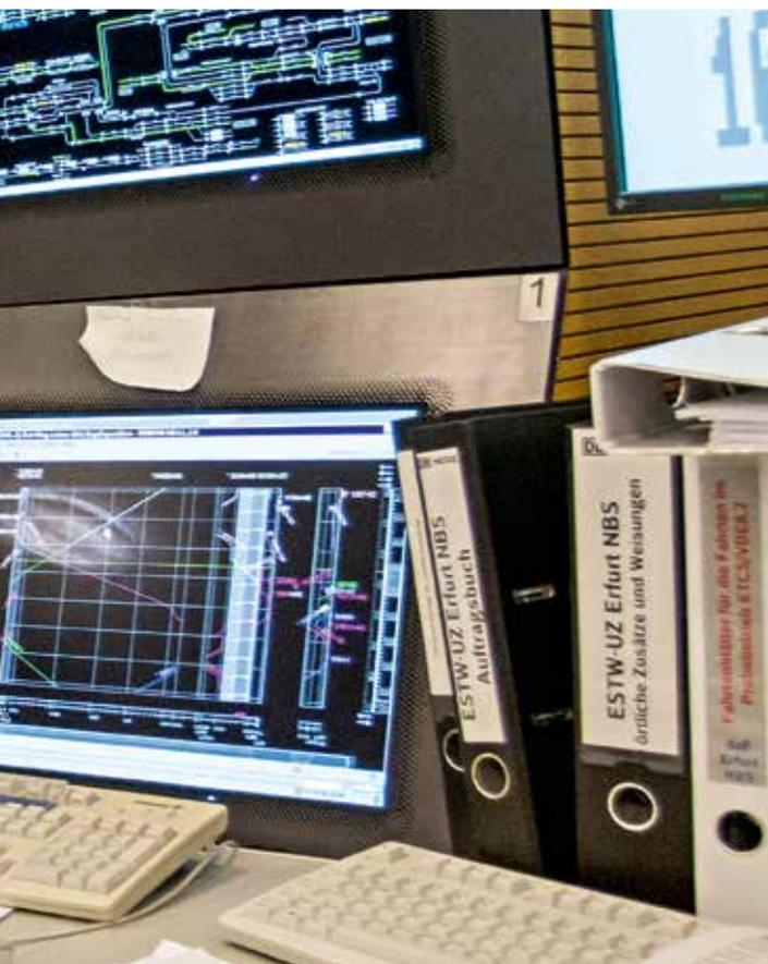
Digitale Zugleitsysteme machen Signale an der Strecke überflüssig. Im Bild: Betriebsleitzentrale mit Computerarbeitsplatz für die ETCS-Strecke.
