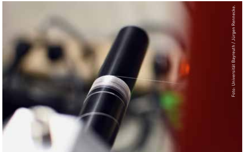
Verstreckung einer multifibrillaren Polyacrylnitrilfaser.
