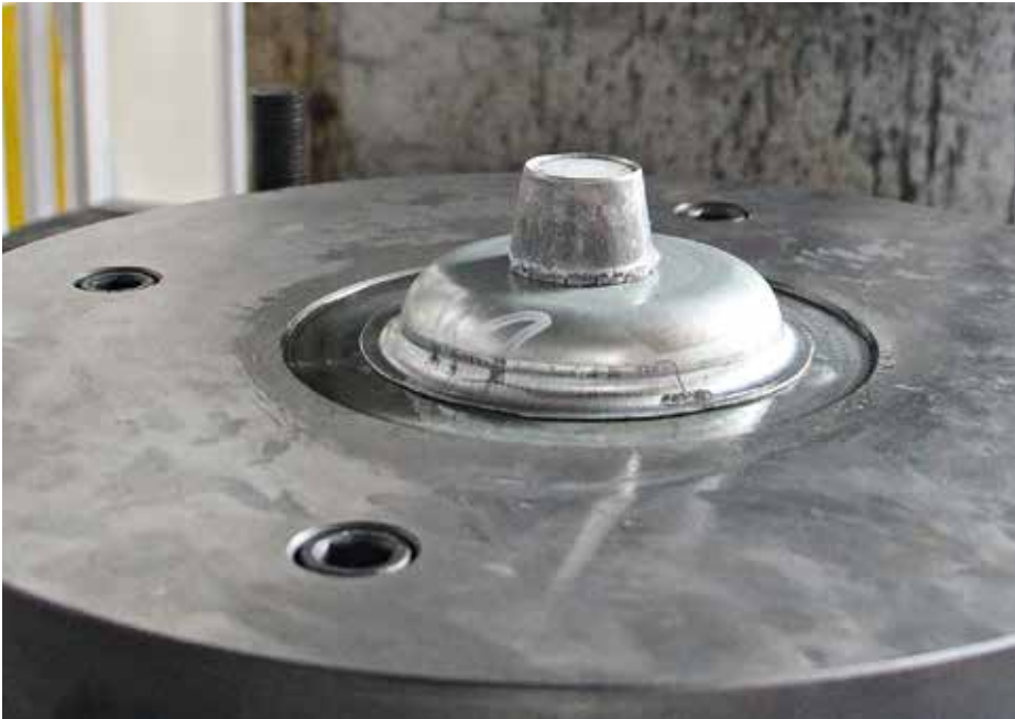
Schmieden statt Schweißen: Bei diesem Versuchsbauteil wurde ein Aluminiumbolzen und ein Stahlblech durch Umformung verbunden, anschließend wurde das Blech tiefgezogen.
