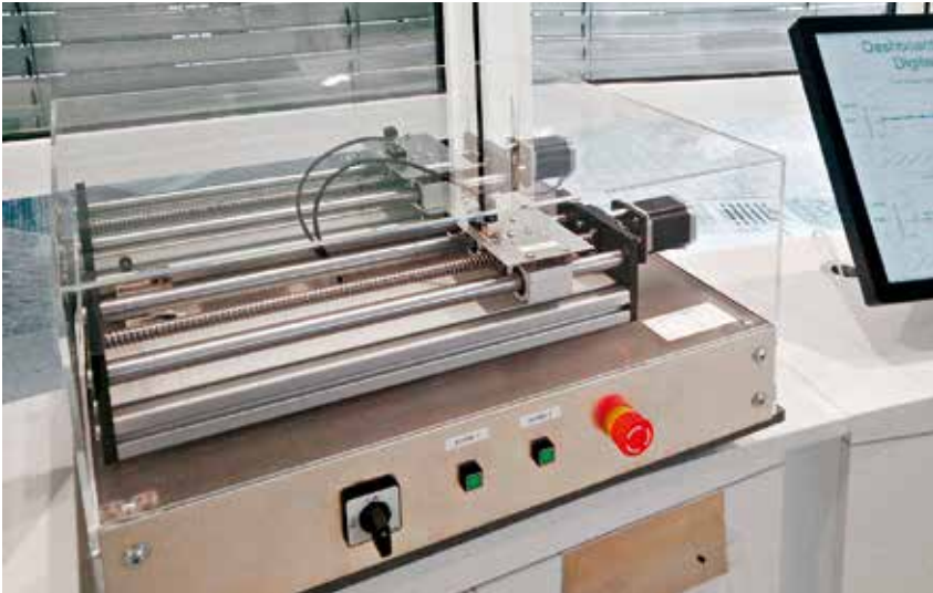
Mit den Daten ab in die „Wolke“: Demonstratoraufbau mit zwei Umlaufspindeln.
