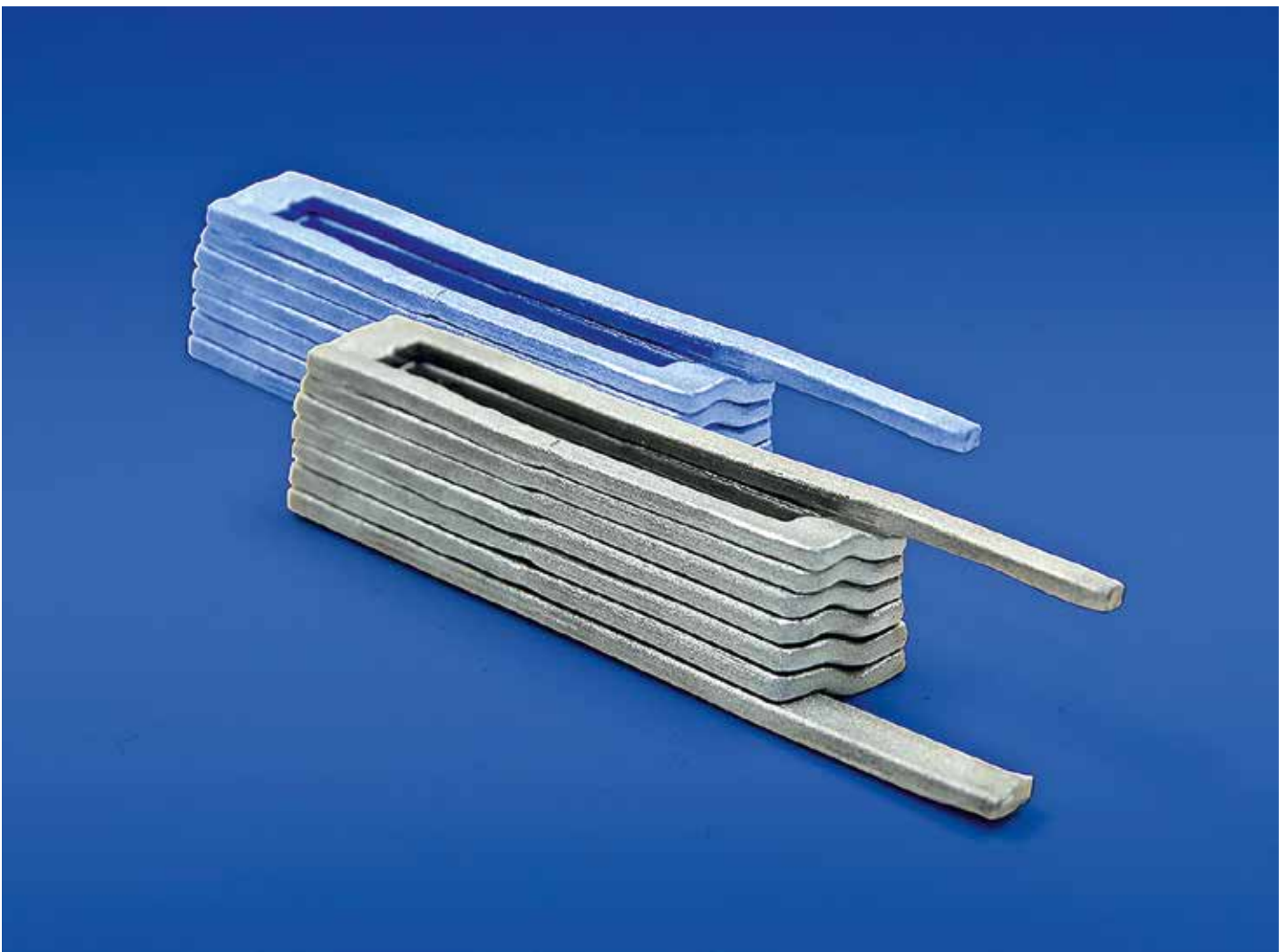
Im Druckguss hergestellte Aluminiumspule mit sieben Windungen und einer Leiterhöhe von ca. 1,5 mm.
