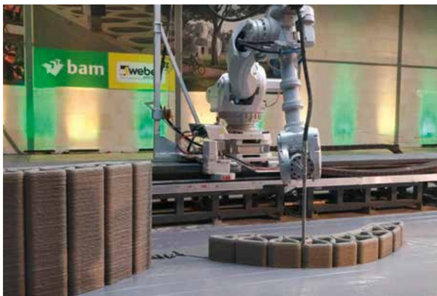
Additive Fertigung bei Saint-Gobain. Der Baustoffbereich setzt auf den 3D-Druck mit neuen Materialien.
