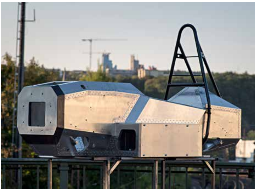
Nachhaltiger als Carbon: Chassis aus Aluminium
