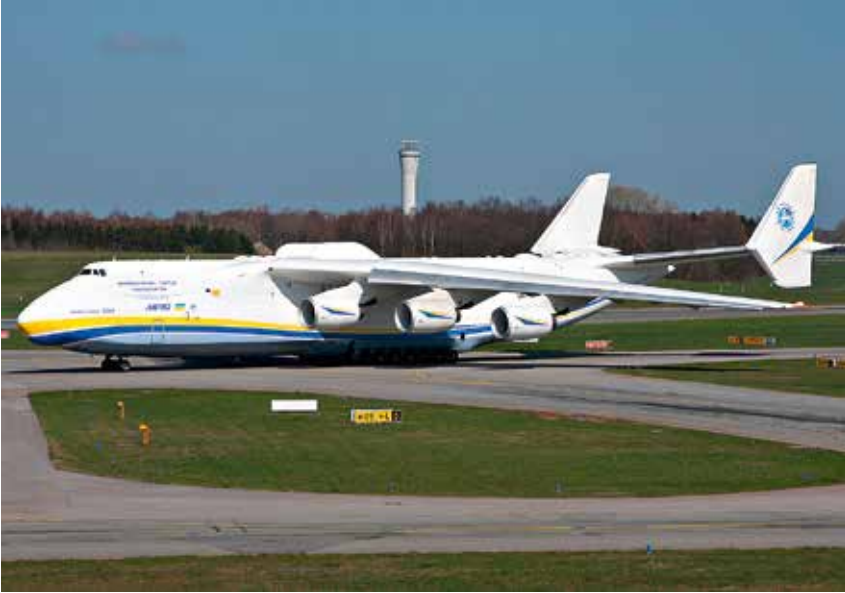
Die Antonow An-225 gilt als das größte Frachtflugzeug der Welt mit einer maximalen Startmasse von 610 t.
