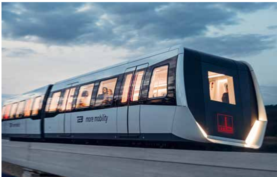
Transport System Bögl: Transrapidähnliche Magnettechnik für den öffentlichen Personennahverkehr.
