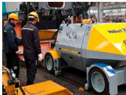
Rangierbetrieb bis 600 t: Neuer 2-Wege Robot für Gleis und Straße.
