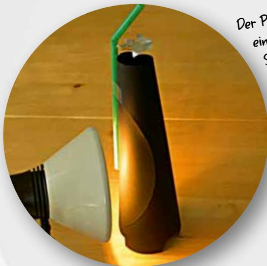
Der Propeller deiner Sonnenturbine reagiert auf jeden Windstoss. Nur an einem völlig windstillen Ort kannst du den Effekt zeigen, dass die Sonne allein die Luft in der Turbine bewegen und damit den Propeller antreiben kann.
