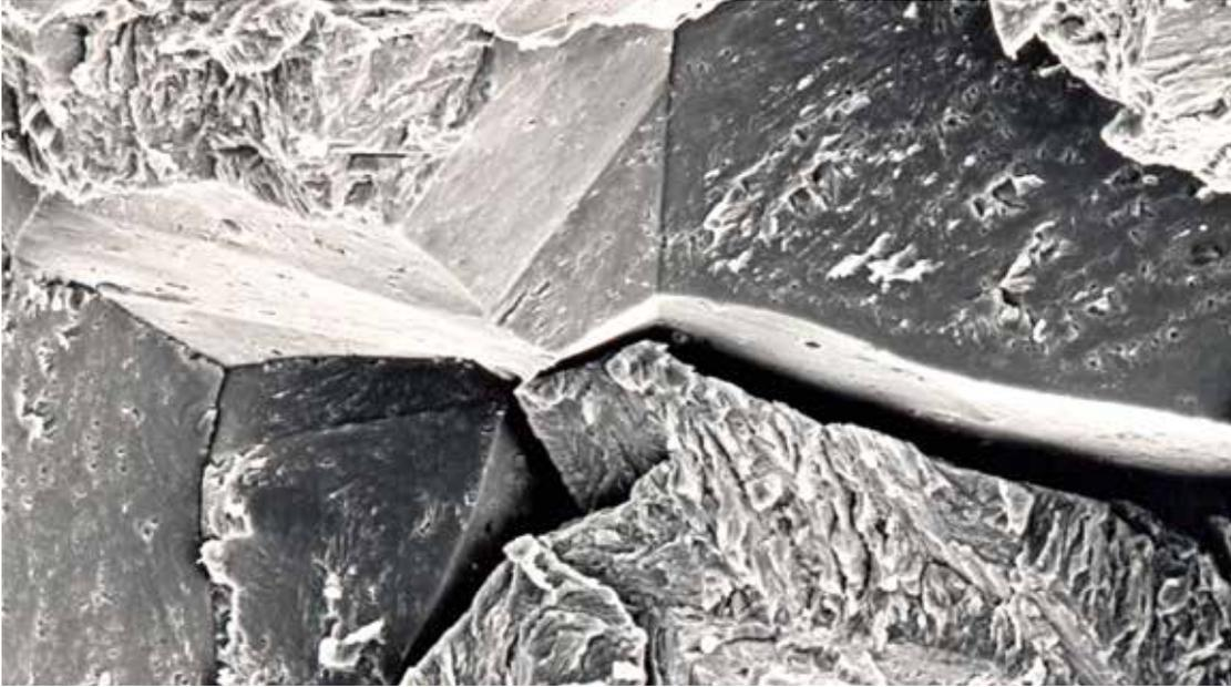
REM-Aufnahme eines Wasserstoffrisses interkristallin 10 µm
