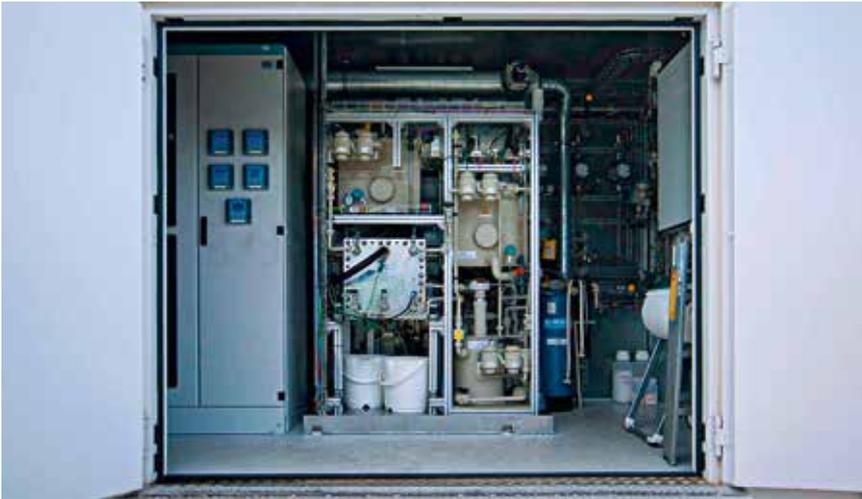
Der weltweit erste vollautomatische CO-Elektrolyseur von Siemens Energy produziert Kohlenmonoxid und Wasserstoff, die Bakterien in einem Bioreaktor zu Spezialchemikalien verarbeiten.
