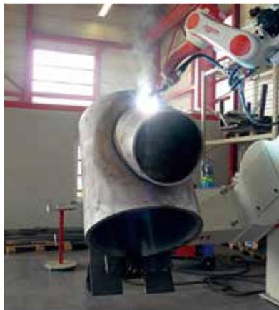
Roboter-gestützte schweißtechnische Fertigung von Jacket-Knoten.
