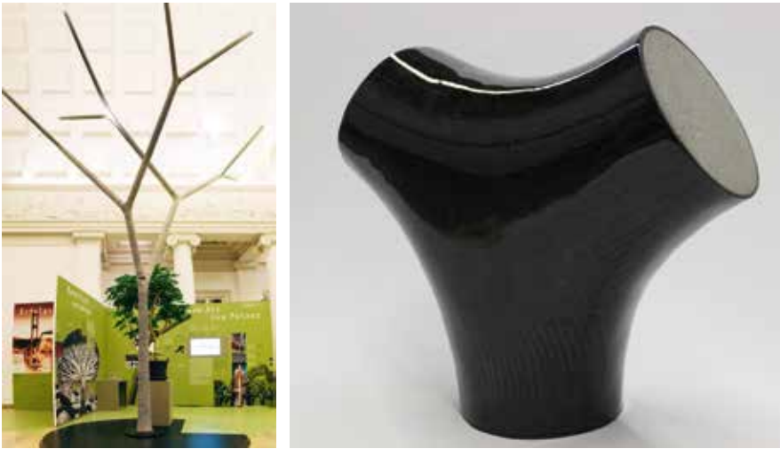
Bild links: Verzweigte, geflochtene Tragkonstruktion bestehend aus Knotenelementen und geraden Stützen in der Ausstellung „baubionik – biologie beflügelt architektur“ im Naturkundemuseum Stuttgart, Schloss Rosenstein. Bild rechts: Zum Patent angemeldet: Tragknoten aus Beton mit Faserverbundkunststoffhülle.
