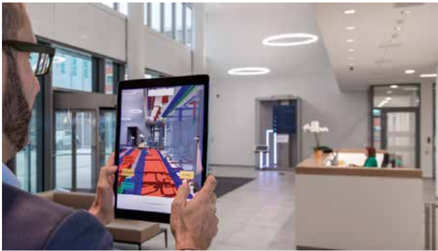
Blick hinter die Fassade: Im Building Twin, dem digitalen Zwilling des Gebäudes, sind detaillierte Informationen hinterlegt. Eine App zeigt diese vor Ort an.
