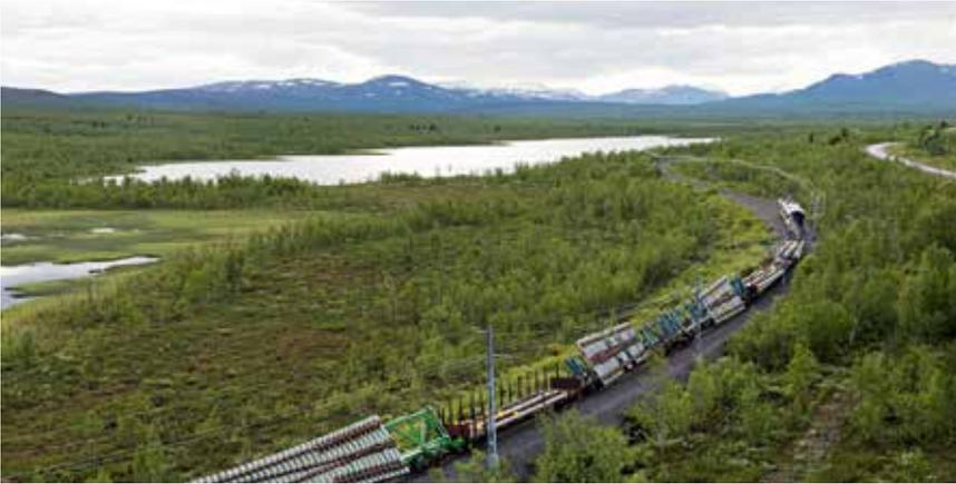
Um 30% verkürzte Weichen-Einbauzeit dank vormontierter Module, Plug & Play-Lösungen und einer Just-in-Time-Logistik auf Spezialwaggons – umgesetzt u.a. in Skandinavien.
