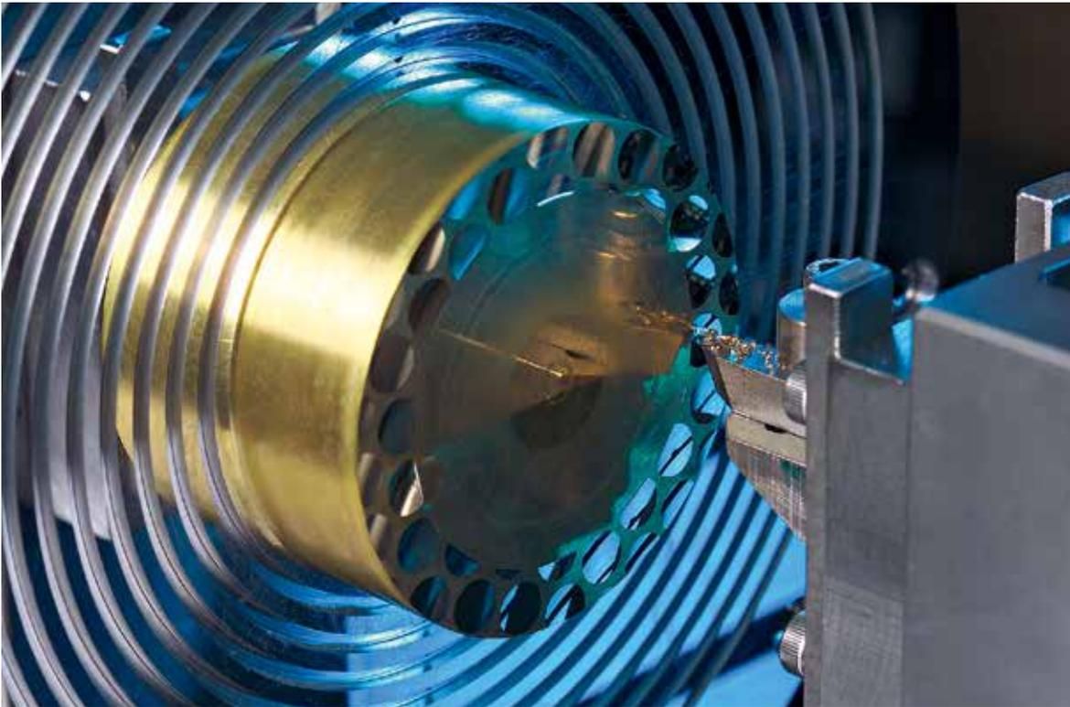
Ultrapräzisionsdrehen einer Mikrolinsenstruktur.
