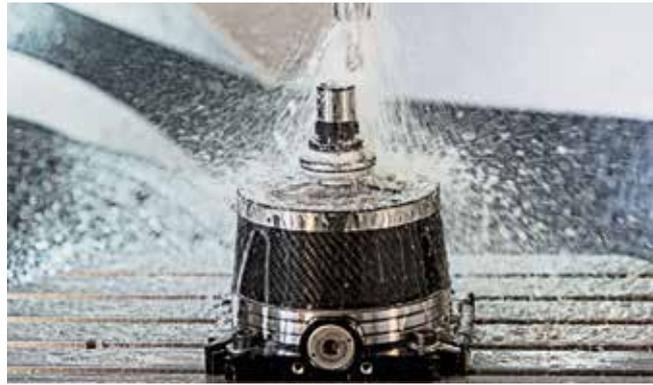
Zu den smarten Spannmitteln zählen Leichtbauprodukte wie der manuelle Spannstock Manok aus Carbon – hier zur letzten Metav 2020.
