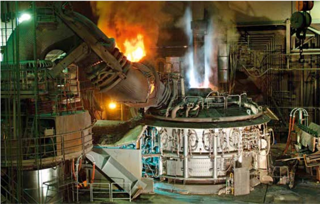
Elektrolichtbogenofen des Stahlwerks Georgsmarienhütte (GMH) bei Osnabrück. Die Elektrifizierung von Prozessen und Anwendungen ist die Voraussetzung für die Energiewende. Die GMH-Gruppe will die Prozesse und den Energieeinsatz weiter optimieren.
