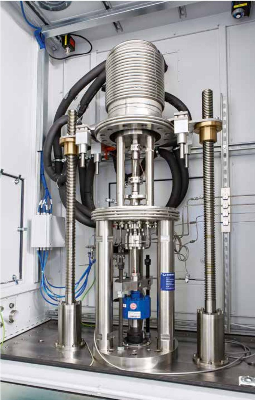
Versuchseinrichtung zur Durchführung von temperierten Ermüdungsversuchen unter Druckwasserstoff und Stickstoff im Fraunhofer LBF.
