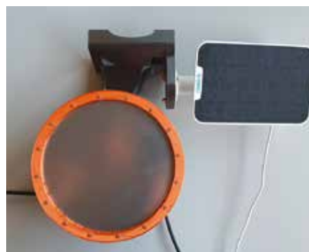
Bild 1: Regensensor mit Solarmodul
