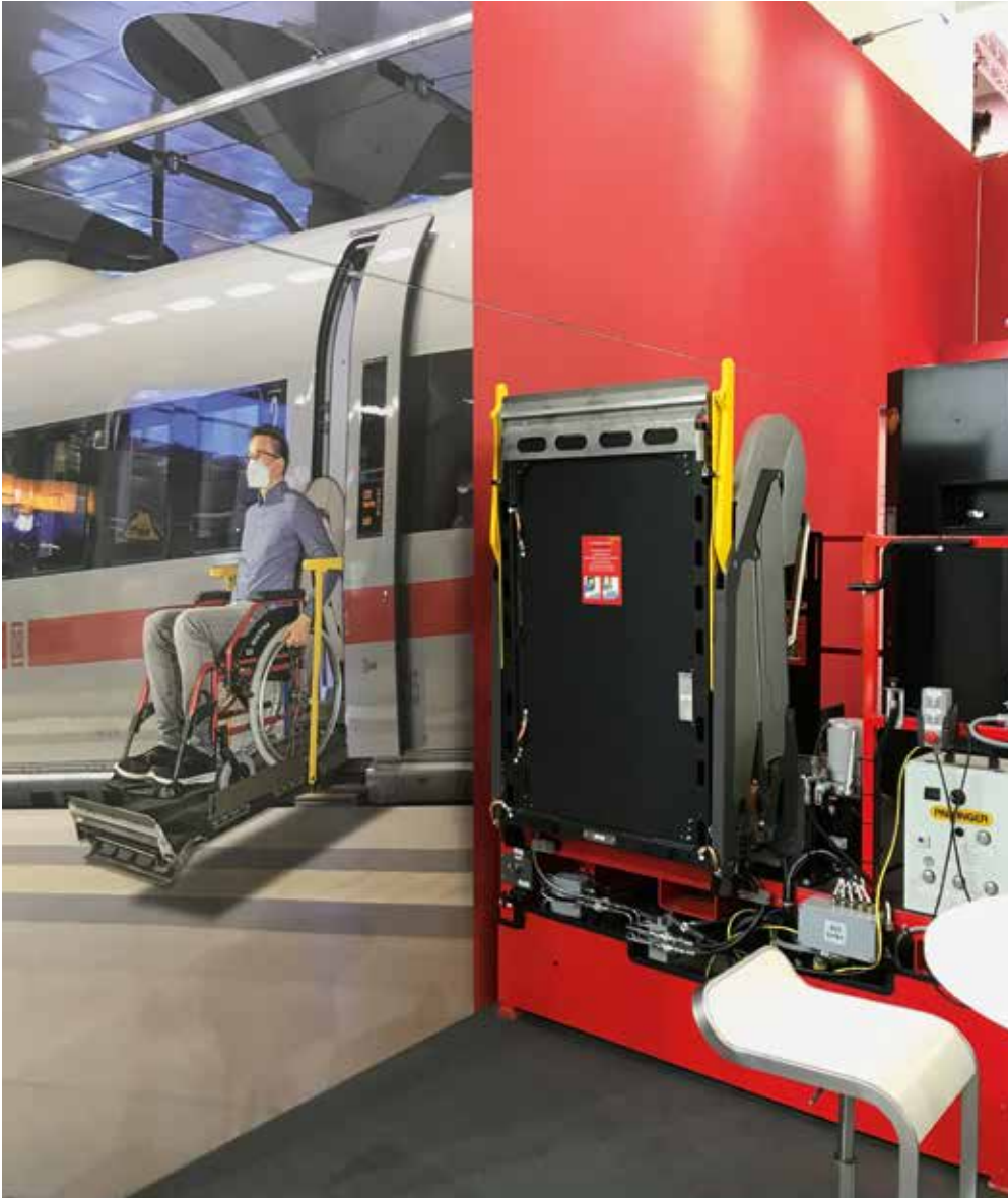
Der Rollstuhllift TRV 2 ist in eingeklapptem Zustand sehr kompakt und platzsparend.
