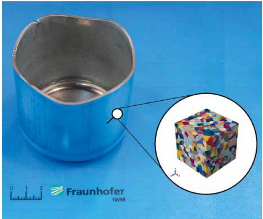
Zipfelbildung im Randbereich d. tiefgezogenen Napfes hervorgerufen durch die richtungsabhängigen Eigenschaften im Blechwerkstoff. Mit d. Virtuellen Labor wird ein Mikrostrukturmodell des Blechwerkstoffs aufgebaut und die Richtungsabhängigkeit vorhergesagt.
