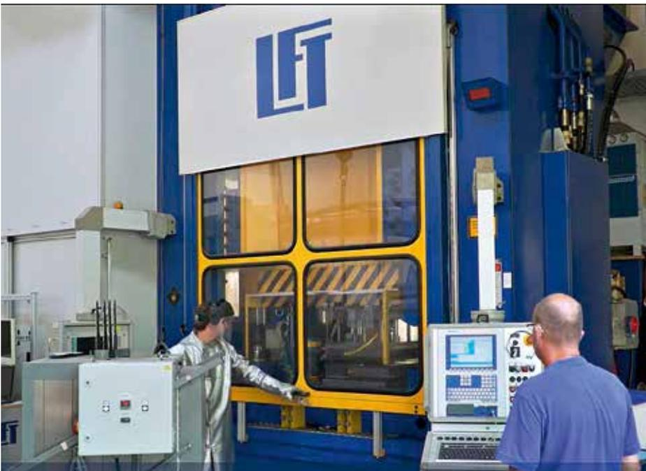
Trockentiefziehen am LFT Erlangen.
