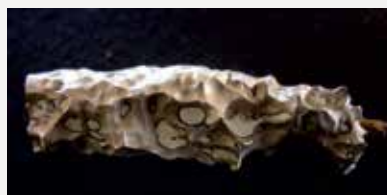
Schnittmodell und eine halb verbrauchte Schutzanode eines ELYSATOR TRIO 10.1-Gerätes.
