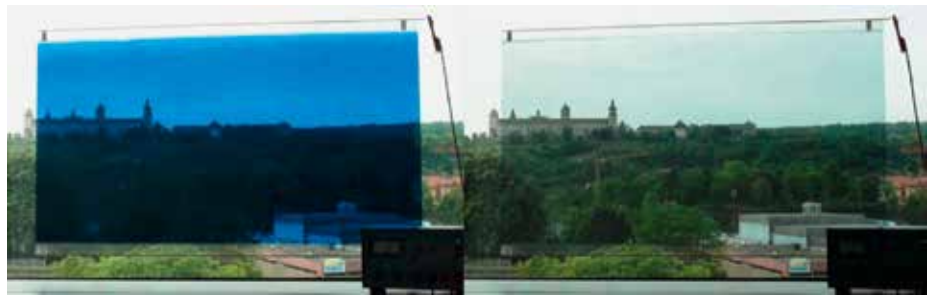
Lichtdurchlässigkeit je nach Bedarf einstellen: elektrochrome Folie im dunklen (links) und hellen Zustand (rechts)
