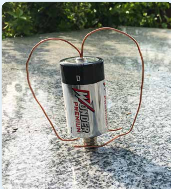
Homopolarmotor aus Kupferdraht, Batterie und Magneten.
