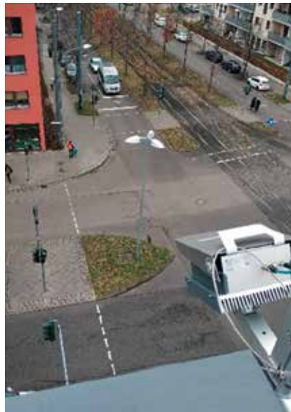
Sensor für die Erfassung aller Verkehrsteilnehmenden im Kreuzungsbereich.
