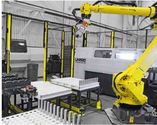
Inspektionsstation der 4-Spindel-Zelle.
