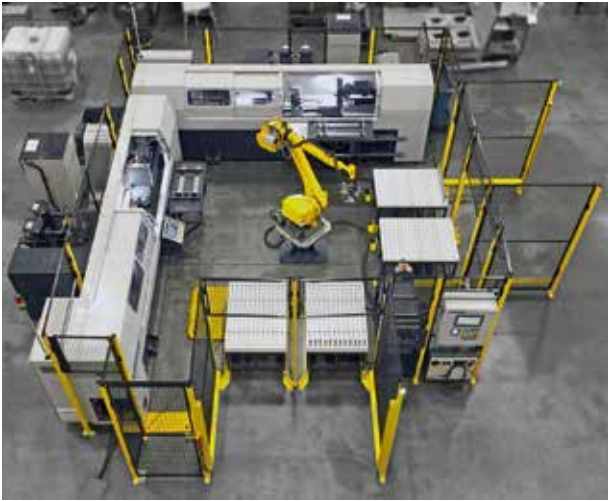
4-spindlige Tiefbohrzelle vmit flexibler Automatisierung.
