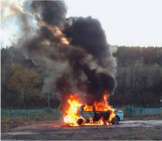
Wenn ´s im E-Auto brennt: Neben schwarzem Rauch gibt es insbesondere im Bereich der Batterie hellen und leicht bläulichen Rauch.
