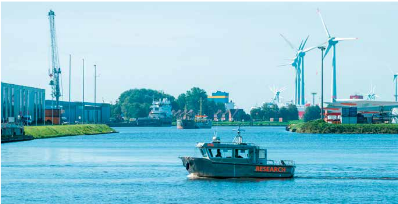
DLR-Forschungsboot „Sally“ im Emdener Hafen: Mit Kameras, Sensoren und Assistenzsystemen ausgestattet erprobt Sally das autonome Fahren auf dem Wasser im Hafen von Emden.
