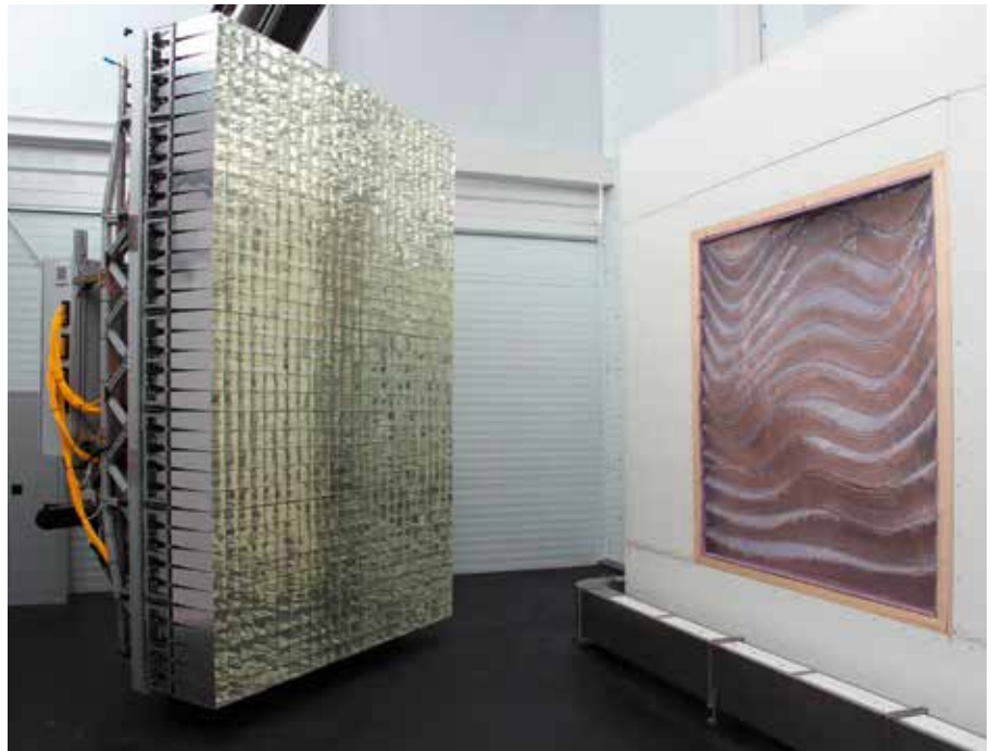
Eine halbtransparente Fassade aus gedrucktem Polymer ist bereit für den Test mit der künstlichen Sonne.
