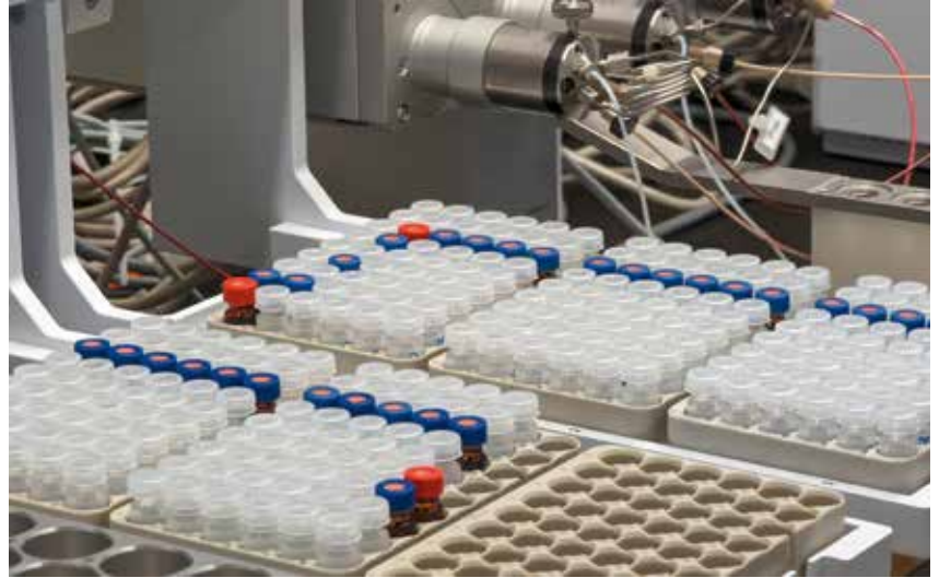
Analytische Bestimmung von PFAS-Proben mittels Flüssigchromatographie mit Massenspektrometrie nach Filtrierung.
