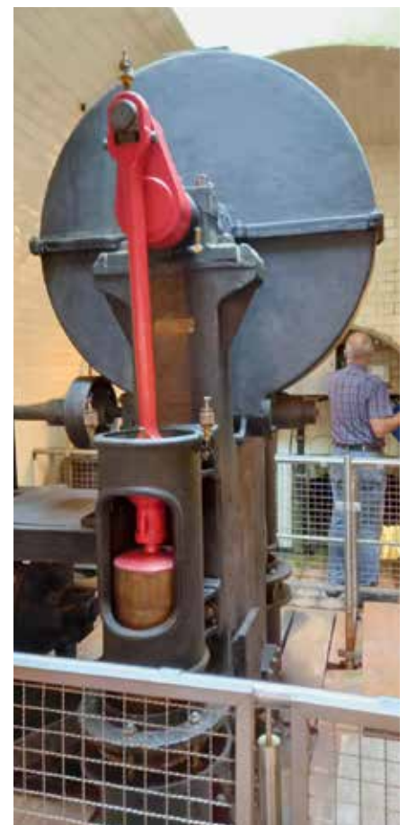
Die Solepumpe, darüber befand sich die Dampfmaschine.
