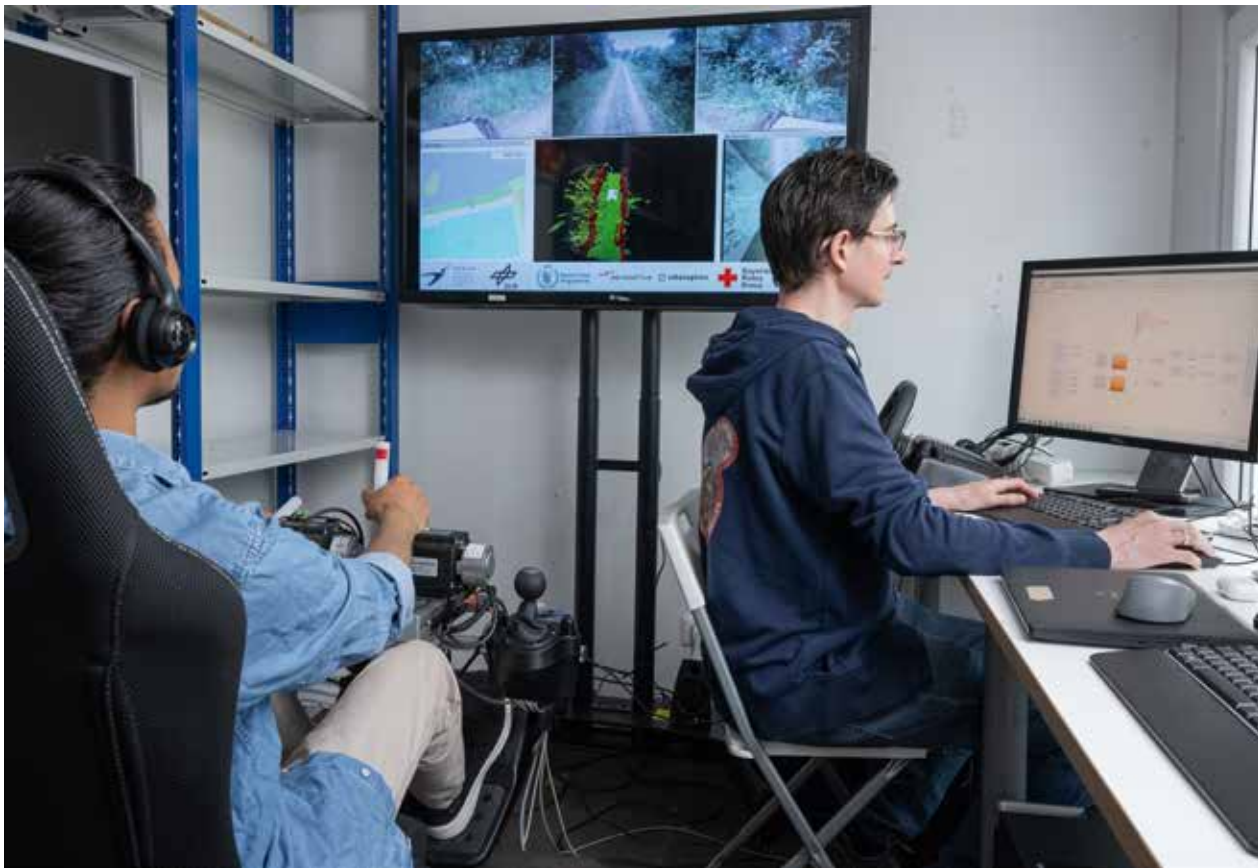
Fernsteuerung des Geländefahrzeugs im Projekt Ahead. Von einem Leitstand wird das geländegängige Fahrzeug ferngesteuert. Dazu kommt Telerobotik-Technologien aus der Raumfahrtforschung zum Einsatz.
