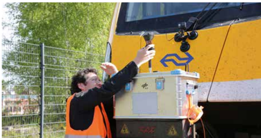
Für die ersten Praxistests war das vom DLR entwickelte System in zwei kompakten Boxen auf den mechanischen Kupplungen an den Zugnasen befestigt.
