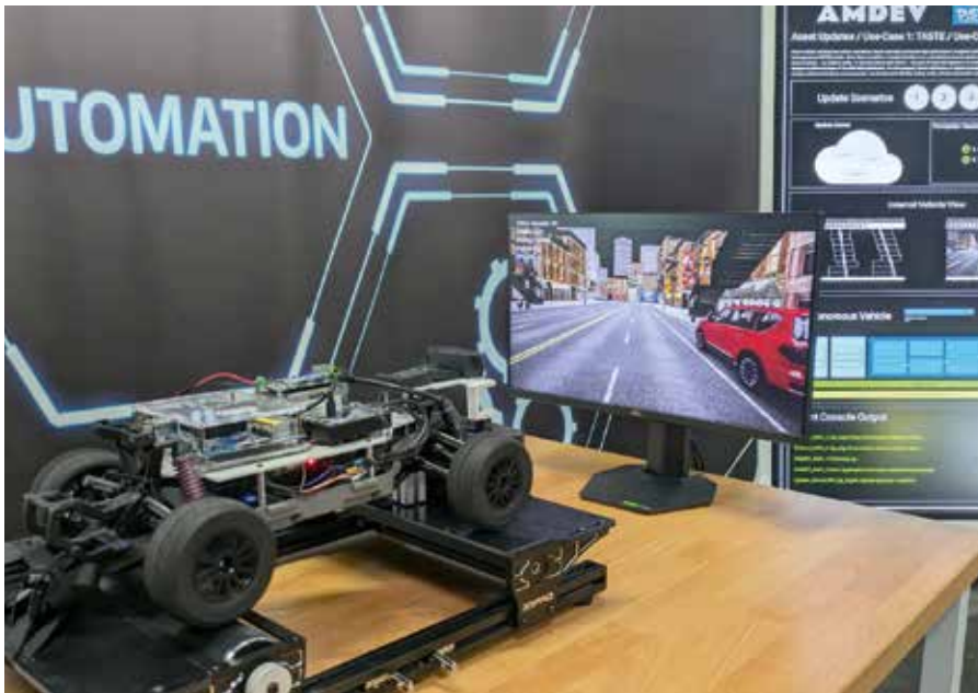
AMDEV-Bed: Entwicklungs- und Demonstrationsumgebung. Das DLR entwickelt einen speziellen Update-Prozess für zukünftige Software-Defined-Vehicles.
