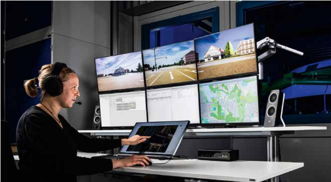
Arbeitsplatz für Technische Aufsicht autonomer Fahrzeuge: Um die Einführung des autonomen Fahrens zu unterstützen, hat das DLR einen Arbeitsplatz für die Technische Aufsicht entwickelt. Im Fokus steht dabei die Schnittstelle zwischen dem Menschen, der aus der Ferne bei Bedarf eingreift, und den autonomen Fahrzeugen.
