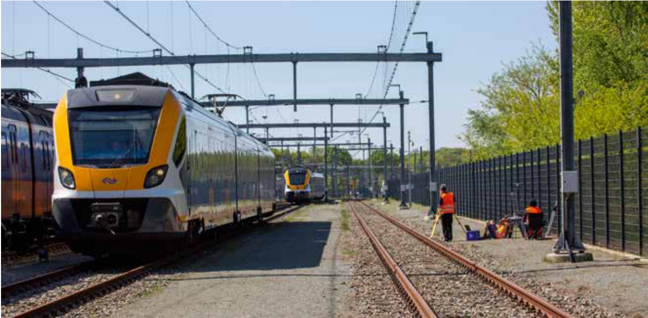
Auf einer Technikfläche der Niederländischen Staatsbahn in Amersfoort bestand das R2DATO-System seinen ersten Praxistest. Auf einer Strecke von 350 m fuhren zwei mit dem DLR-System ausgerüstete Regionalzüge mit für den Bahnverkehr geringen Abständen von 15 bis 80 m hintereinander.
