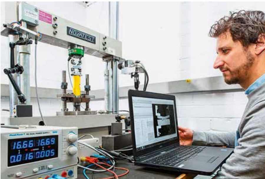
Experimentelle Schwingfestigkeitsanalyse zur lokalen Schwingfestigkeitsbewertung von Stahl-Aluminium-Schweißnähten mithilfe digitaler Bildkorrelation.
