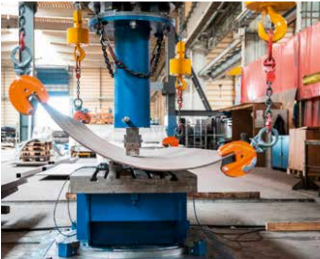
Das 3D-Messsystem ermöglicht den Soll-Ist-Vergleich bei der kaltplastischen Umformung von Stahlblechen in Echtzeit.
