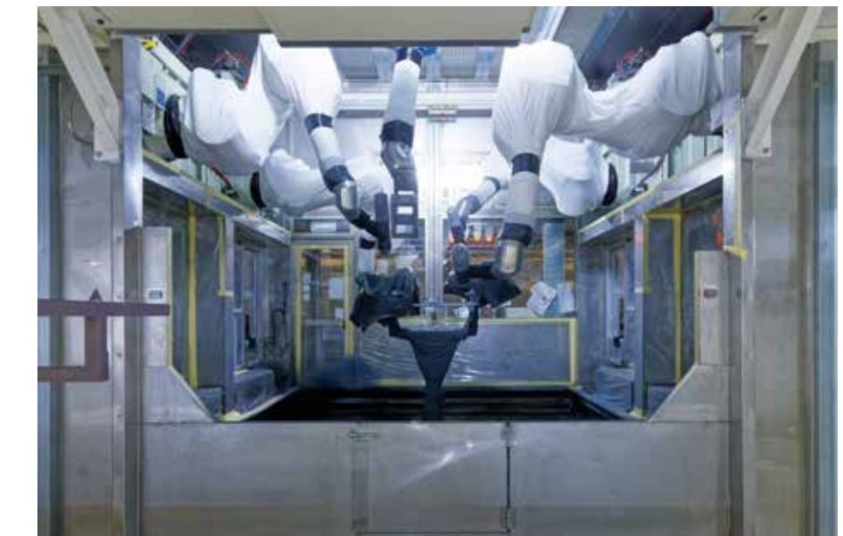
Für Menschen gefährliche oder einfache Aufgaben können vollautomatisiert von Robotern übernommen werden, wie hier das Sprühlackieren von Stoßstangen.
