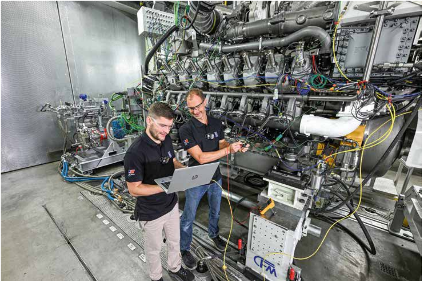
Der erste schnelllaufende, reine Methanolmotor hat bei Rolls-Royce auf dem Prüfstand seine Premiere gefeiert.
