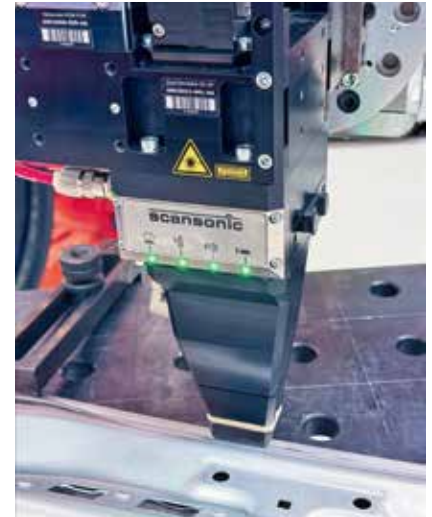
Die neue Laserschweißoptik SCW kann in einer Produktionsumgebung ohne Laserschutzzelle betrieben werden.
