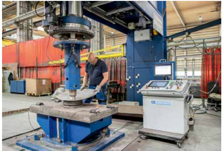
Ein Werker bei der Formung eines Probestücks. Dank des Messsystems kann bei der Umformung auf den Einsatz von Prüfschablonen verzichtet werden.
