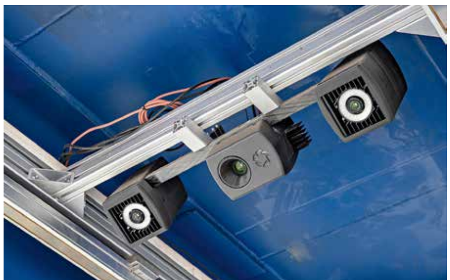
Das Sensornetzwerk besteht aus zueinander synchronisierten Kameras und je einem Projektor zur Musterprojektion für die digitale 3D-Erfassung.
