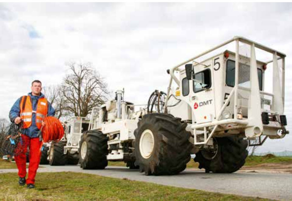
Solche sogenannten Vibro-Trucks waren 2025 in Wuppertal unterwegs, um seismische Messungen durchzuführen
