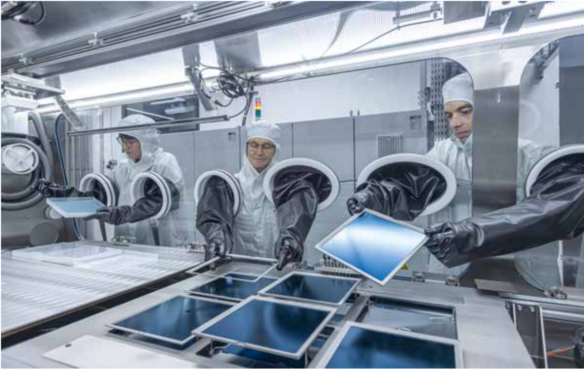
Das Pero-Si-Scale überführt die Zell-designs aus dem Labor auf industrielle Zellformate bis zur Wafergröße von 210 Mal 210 mm 2 .
