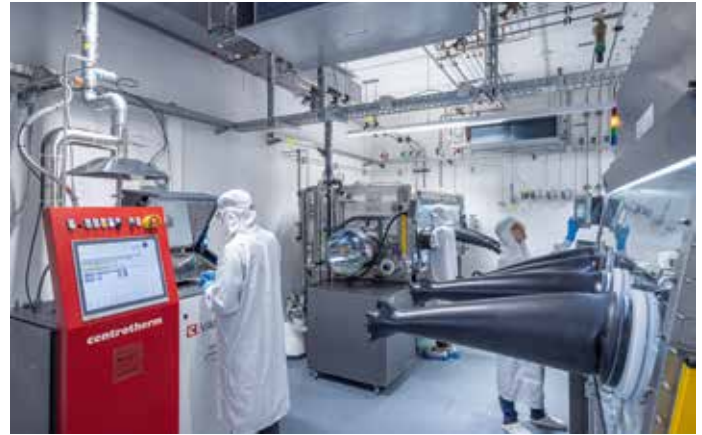
Das Fraunhofer ISE setzt beim Herstellungsverfahren für Perowskit-Silizium-Tandemsolarzellen auf die sogenannte „Hybrid-Route“, der Kombination von Vakuum- und nass-chemischen Prozessen.
