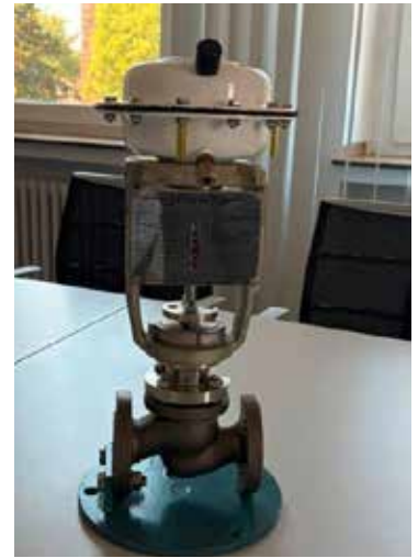
Sicherheitsarmatur als Anschauungsobjekt.
