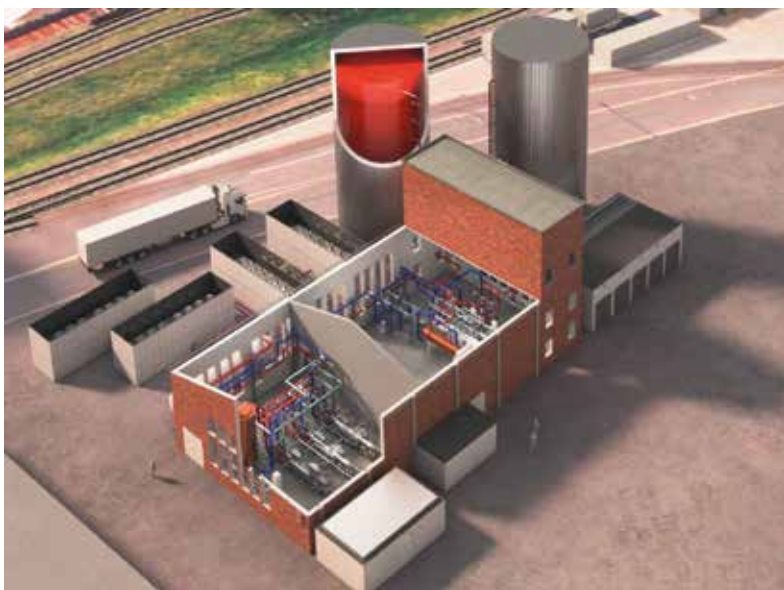
3D-Modell der Power-to-Heat-Anlage der SMS group.
